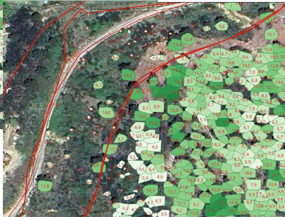
Fig. 1 — Caractérisation par LiDAR haute densité d'un ouvrage DFCI colonisée par le pin d'Alep. La segmentation des houppiers et l'analyse du nuage de points objectivent une structure hétérogène et un couvert très ouvert : indice de diversité structurale 2,36, indice foliaire (LAI) 0,33, fraction de trouées (Gap Fraction) 84,8 %, rugosité de canopée 3 m, avec seulement onze arbres de plus de six mètres par hectare. Ces indicateurs traduisent un milieu majoritairement combustible et sans valeur sylvicole.
